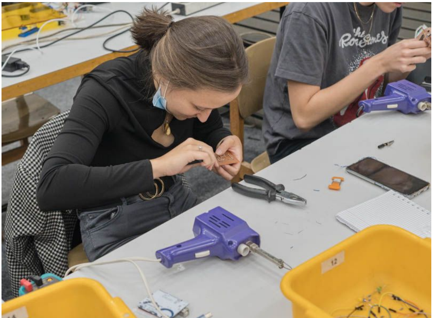
Obr. 4: Pájení na univerzální plošný spoj.
